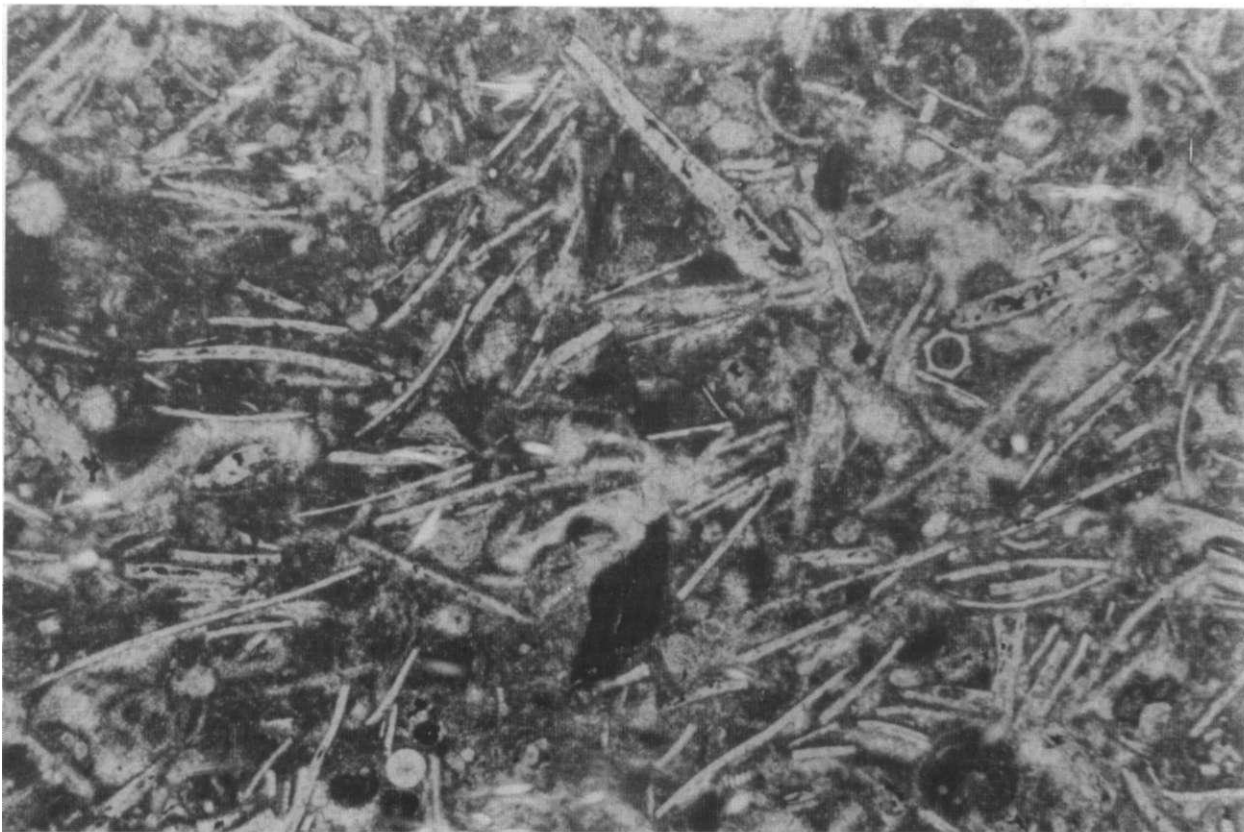
Obr. 7-13. Mlži. Juvenilní (mladá) stadia mlžů rodu Bositra žijí planktonním způsobem života. Jejich tenké, velmi malé schránky dávají vápencům ve výbrusu charakteristický vzhled („vláknová“ mikrofacie). Vpravo nahoře je řez schránkou břichonožce, vpravo uprostřed příčný kruhový řez schránkou bentózního dírkovce. Dogger, Manin. Výbrus, zv. 35x. Foto J. Krhovský.
