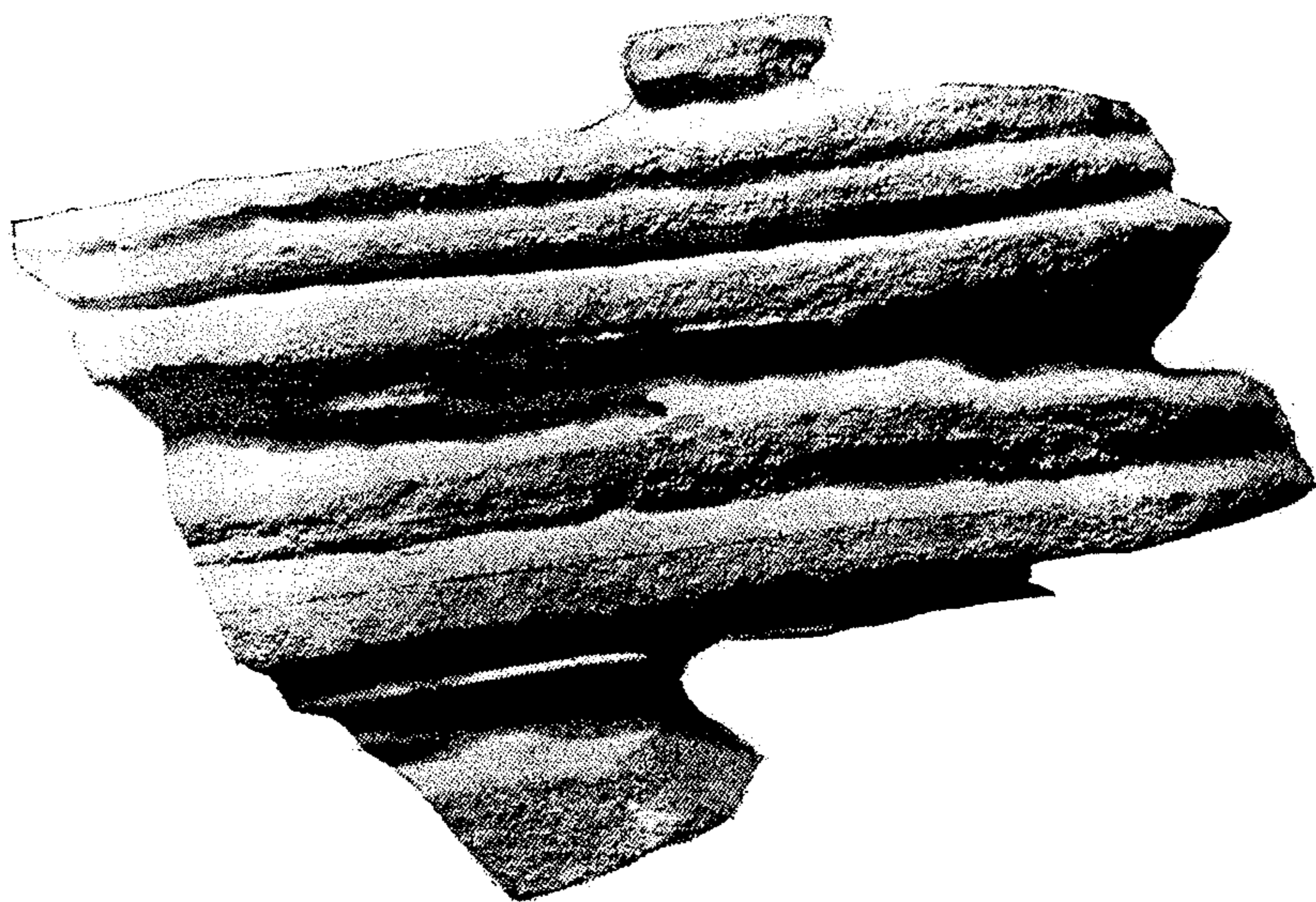
Abb. 219. Verwitterung von aus der Umwandlung algonkischer Schiefer am Kontakt mit Granit entstandenem Kontakthornfels . Die gesimsartige Verwitterung der Oberfläche entspricht der ursprünglichen Hornfelsschichtung. Tal der Kocába bei Rybník südlich von Dobříš. Sammlung des Geologischen Instituts der Karlsuniversität. (Sammlung und Foto R. KETTNER.)
